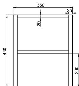
Fenólico en horizontal sale 15 mm para cada lado y tiene 12 mm de grosor por 170 mm de ancho.
