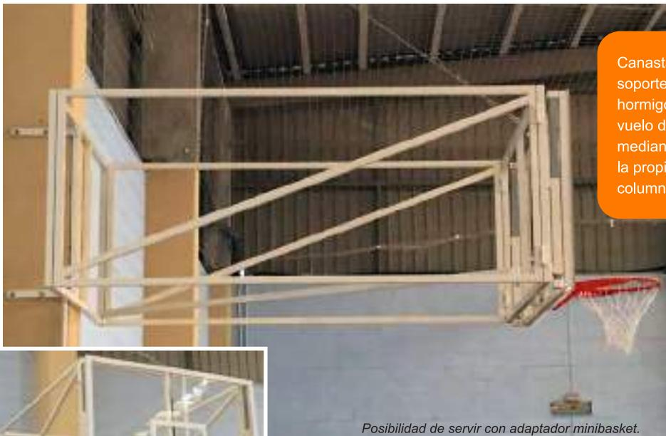
Canasta abatible de 2,50 mts colocada en columna mediante soportes metálicos a medida que se atornillan al propio hormigón de la columna, a su vez, debido al ser de mayor vuelo de 1,50 mts se le colocan unos tirantes superiores mediante cableado para dar más estabilidad y seguridad a la propia canasta. Tanto el cableado, como la estructura a la columna se presupuesta aparte.
